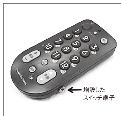
図3 スイッチ大きめのマルチTVリモコン(スイッチ入力端子増設加工済)
