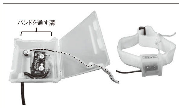
図9 マイクロスイッチを用いた引っ張りスイッチ
