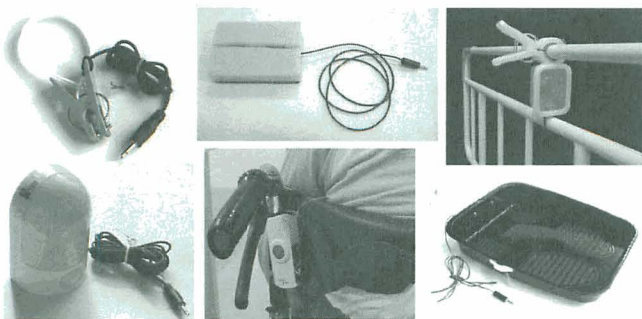
図2 院内で用いられている危険防止用の手作りセンサの例 引き抜きセンサ、立ち上がりセンサ、ベッド柵振動センサ、赤外線センサ、車椅子立ち上がりセンサ、靴置きセンサ
